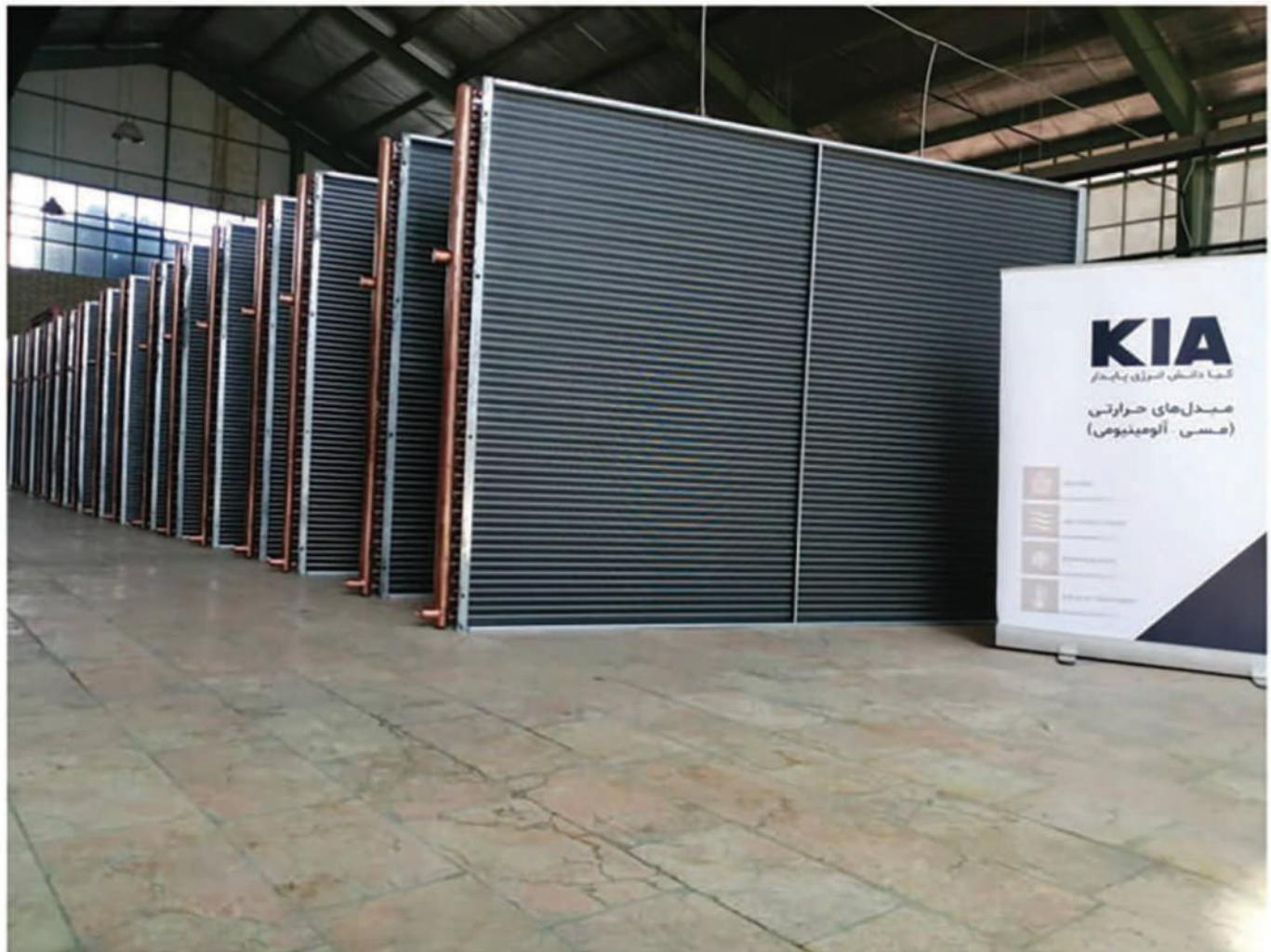
شرکت کیا دانش تولید کننده‌ی کویل‌های مس - آلمینیومی (به عنوان مبدل حرارتی بین هوا با هر نوع سیال اولیه) می‌باشد. این کویل‌ها مطابق نقشه‌ی اختصاصی مشتریان تولید می‌شود. این شرکت با بهره مندی از دانش به روز، استفاده از ماشین آلات پیشرفته و با اتکا به ۵۰ سال تجربه تولید انواع ماشین آلات و محصولات صنعتی موسس خود، مناسبترین راهکارهای اقتصادی و فنی را برای مشتریان خود تامین نموده است.
