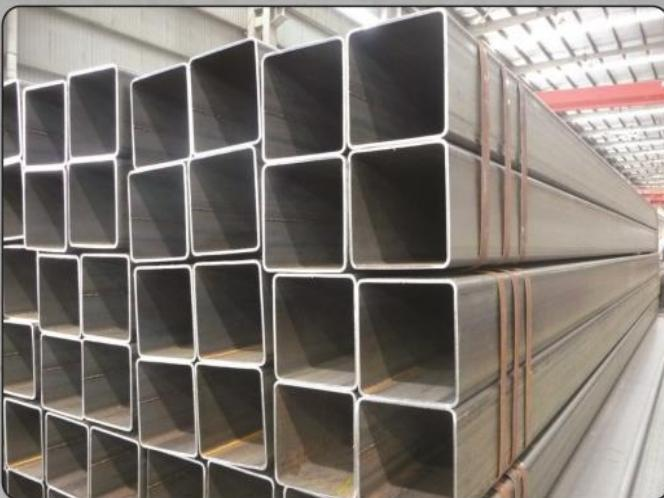
استاندارد های تولید این نوع مقاطع EN 10219 و ASTM A500 می باشد که کارخانجات کالوپ قادر است بر اساس نیاز مشتری انواع مختلف گرید فولاد (از ST37 الی ST52) تولید نماید.
